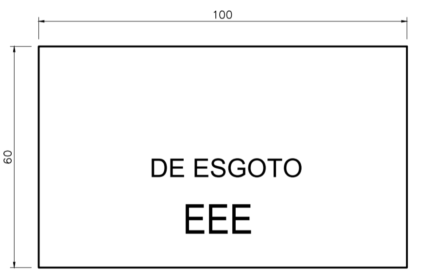
DETALHE DA PLACA DE IDENTIFICAÇÃO ESC. 1:20
