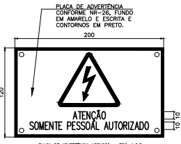
PLACA DE ADVERTÊNCIA CONFORME NR-26, FUNDO EM AMARELO E ESCRITA E CONTORNOS EM PRETO.
