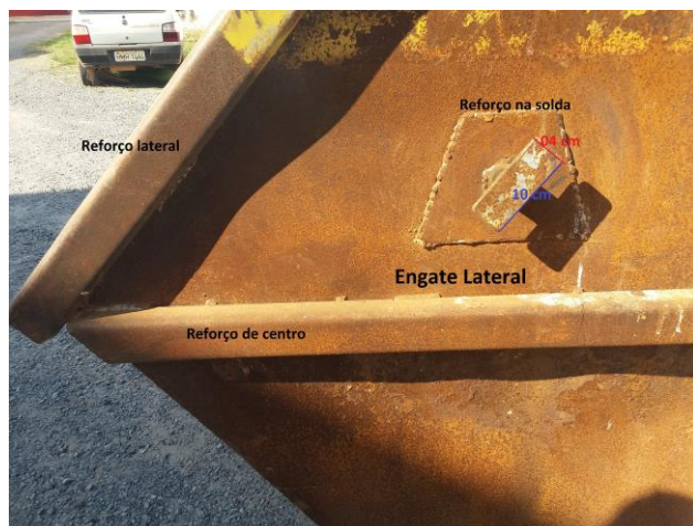
Foto 03: Reforços e engate lateral
